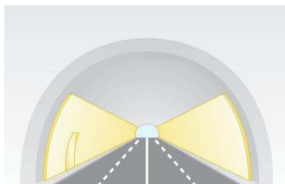
Revestimento de paredes
