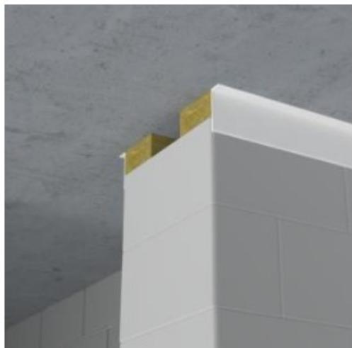
Junta entre parede e teto com duas placas
